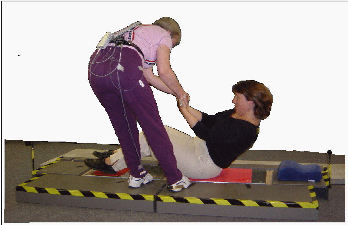
Abbildung 2-36: Situation während der Tätigkeit „Aufrichten des Patienten vom Boden zum Sitzen“; Erfassung der Aktionskräfte mit dem Messsystem „Boden“
