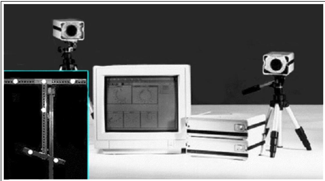
Abbildung 3-1: Optoelektronisches Positionserfassungssystem zur dreidimensionalen Analyse von Körperhaltungen und -bewegungen MacReflex. Links und rechts: Infrarot-Kameras mit integrierten IR-Lichtquellen, mitte-links: Kontrollmonitor, mitte-rechts: Signalprozessoreinheiten, Ausschnitt links: Positionsmarker am Kalibrierungsgestell
